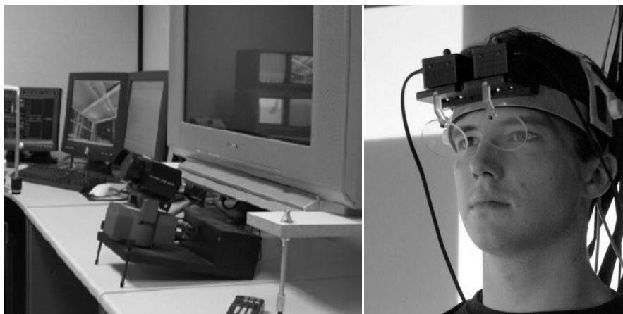
شکل ۵ : سمت راست نمونه ای از یک سیستم ردیاب چشم قابل نصب روی سر
