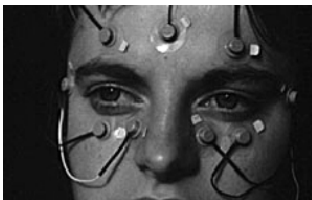
شکل ۵ : الکترود های نصب شده در روش EOG [۵]
