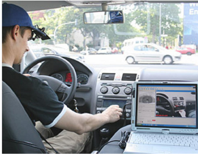
شکل ۳۸: استفاده از ردیاب چشم برای ارزیابی مهارت در رانندگی [۵۰]
