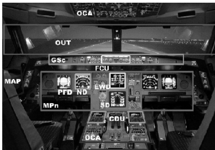
شکل ۳۶: تقسیم‌بندی بخش‌های مختلف کابین یک هواپیمای A330 که خلبان با آنها سرو کار دارد. [۵]
